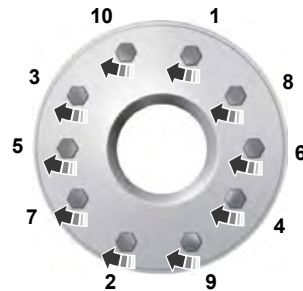
10-lug nut torque sequence
